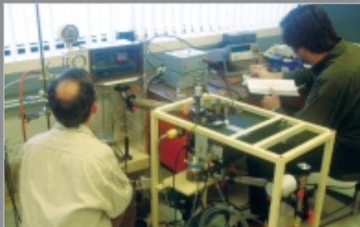
← Balance ultrasensible pour mesurer l'absorption de l'hydrogène dans un nanotube.
