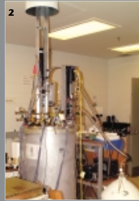
1-Four d'activation du charbon. 2-Banc d'essais pour la liquéfaction magnétique de l'hydrogène. 3-Système de contrôle du banc d'essais des moteurs à combustion interne alimenté à l'hydrogène, à essence ou au gaz naturel.
