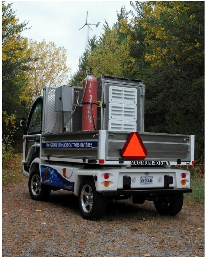
L'UQTR a fait l'acquisition de deux véhicules écologiques à basse vitesse (VBV) de fabrication québécoise, lesquels serviront à tester et optimiser différentes technologies d'utilisation de l'hydrogène comme source d'énergie motrice.
